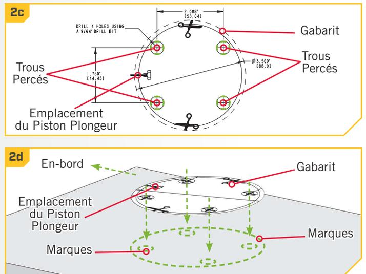
**AVIS :** Percez les trous pour les vis complètement au travers afin d'empêcher des fissures du pont du bateau.
