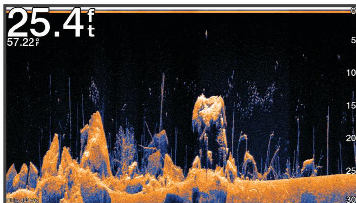
Standardne sonde emitiraju stožasti snop. Tehnologija sonara sa skeniranjem Garmin ClearVü emitira dva uska snopa oblikom slična snopu u uređaju za kopiranje. Ti snopovi omogućuje jasniju sliku, više nalik na fotografiju, svega što se nalazi ispod plovila.
