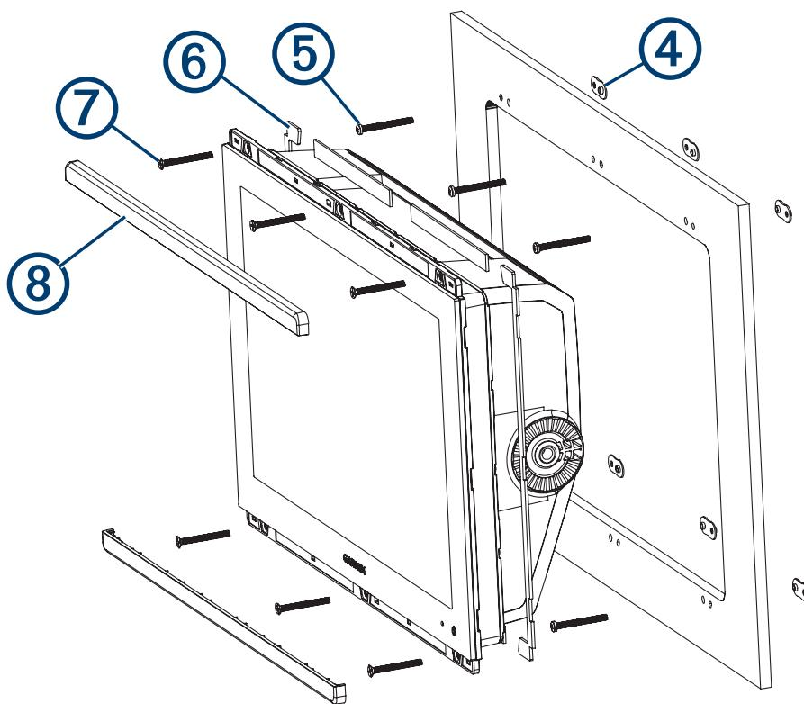
**17** Pričvrstite okvire za maticu na površinu za montiranje zatezanjem običnih vijaka s upuštenom glavom ⑤ kroz unutarnje rupe.
