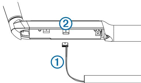
Priklučak se u utor može umetnuti samo u jednom smjeru. Primjenom prekomjerne sile prilikom umetanja priključka u utor možete oštetiti priključak.
