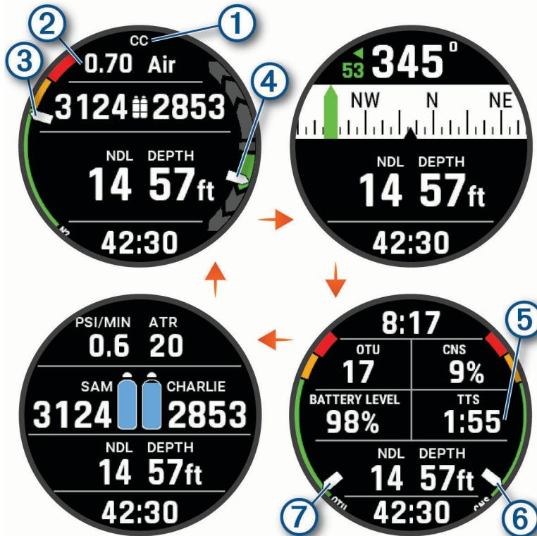
**Zaslonski prikaz primarnih podataka:** Prikazuje glavne podatke o ronjenju, uključujući plin za udisanje i brzinu zarona ili izrona.
