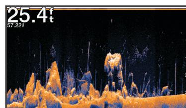
Standardne sonde emitiraju stožasti snop. Tehnologija sonara sa skeniranjem Garmin ClearVÜ emitira dva uska snopa oblikom slična snopu u uređaju za kopiranje. Ti snopovi omogućuju jasniju sliku, više nalik na fotografiju, svega što se nalazi ispod plovila.
