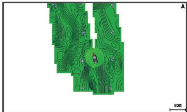
Zeleni krug ukazuje na dobru dubinu i GPS položaj te brzinu manju od 16 km/h (10 mph). Žuti krug ukazuje na dobru dubinu i GPS položaj te brzinu između 16 i 32 km/h (10 i 20 mph). Crveni krug ukazuje na lošu dubinu ili GPS položaj te brzinu veću od 32 km/h (20 mph).
