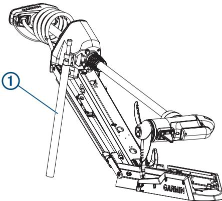
**NAPOMENA:** Ako na vanbrodski motor niste montirali stabilizator, motor biste trebali poduprijeti čvrstim predmetom koji će spriječiti zaključavanje motora u sklopljenom položaju.
