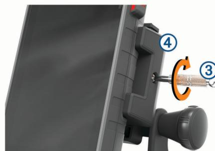
**OBSERVAÇÃO:** o parafuso de segurança é usado para impedir o roubo do dispositivo e ajuda a evitar que você pressione acidentalmente a trava de liberação.
