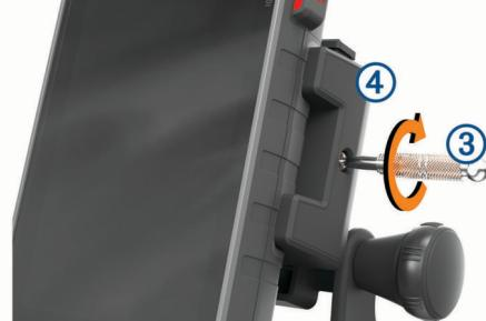
**UWAGA:** Śruba zabezpieczająca zapobiega kradzieży urządzenia i przypadkowemu naciśnięciu przycisku zwalniającego zatrzaszcza.
