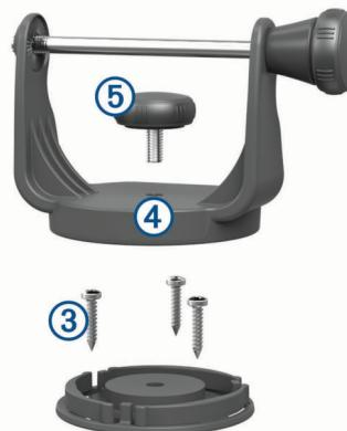
5 Установите поворотный кронштейн **④** на поворотное основание и закрепите его с помощью короткой ручки **⑤**.
