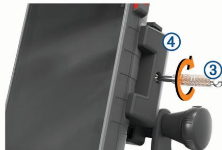
**NOTA:** la vite di sicurezza viene utilizzata per impedire il furto del dispositivo ed evitare la pressione accidentale del fermo di rilascio.
