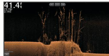
Standardne sonde emitiraju stožasti snop. Tehnologija sonara sa skeniranjem Garmin ClearVü emitira dva uska snopa oblikom slična snopu u uređaju za kopiranje. Ti snopovi omogućuju jasniju sliku, više nalik na fotografiju, svega što se nalazi ispod plovila.
