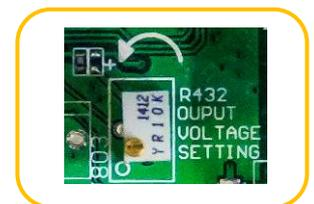
In caso di batterie speciali, rivolgersi ad un installatore professionista che effettuerà le regolazioni particolari in accordo con le specifiche del costruttore degli batterie e tenendo conto delle particolarità dell'installazione.
