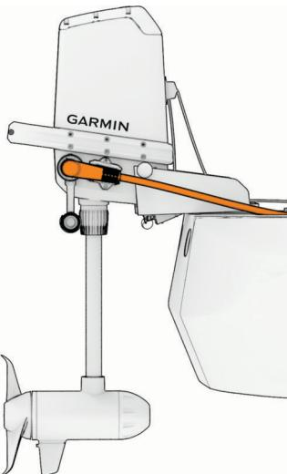
Rasterećenje zatezanja kabela za napajanje naliježe na postolje na kućištu motora.
