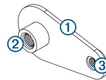
15 Počevši u kutu površine za montiranje, postavite okvir za maticu ④ na stražnju stranu površine za montiranje i poravnajte manje i veće rupe.
