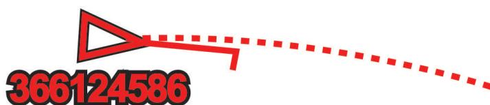
Kada podaci o kopnenom kursu i smjeru dođu iz aktiviranog AIS cilja, bez navođenja podataka o brzini skretanja, planirani kurs cilja izračunava se na temelju podataka o kopnenom kursu.
