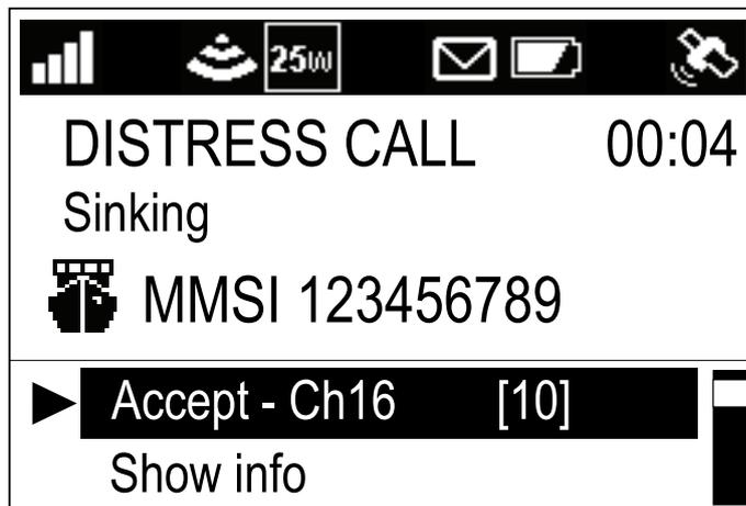
Wenn der **automatische Kanalwechsel** aktiviert ist, wird das Funkgerät 10 Sekunden nach Eingang des Notrufs automatisch auf Kanal 16 umgestellt. Andernfalls wird der Benutzer aufgefordert, den Kanal manuell zu wechseln.
