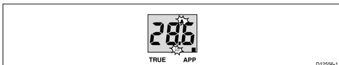
Der **Alarm niedriger scheinbarer Windwinkel** ertönt, wenn der scheinbare Windwinkel kleiner oder gleich dem **Grenzwert für kleinen scheinbaren Windwinkel** ist. Der Warnton ertönt so lange, bis er manuell stummgeschaltet wird.
