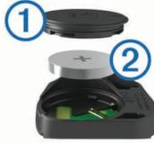
2 Zakrećite poklopac u smjeru suprotnom od kazaljke na satu sve dok oznaka ne bude usmjerena prema otključanom položaju, a poklopac dovoljno olabavljen da se može skinuti.
